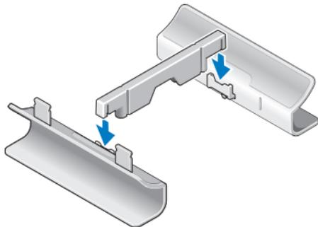
5. Luruskan tab penahan pada dudukan dengan slot pada komputer dan turunkan komputer ke dudukan hingga tab penahan terpasang ke dalam slot.
