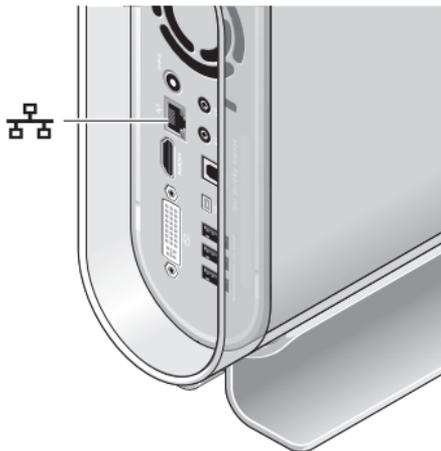
Gunakan hanya kabel Ethernet (konektor RJ - 45). Jangan pasang kabel telepon (konektor RJ-11) ke konektor jaringan.
