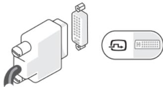
Jika kabel VGA (dengan konektor biru di kedua ujungnya) telah tersambung ke display Anda, lepaskan koneksi kabel VGA dan gunakan kabel DVI.
